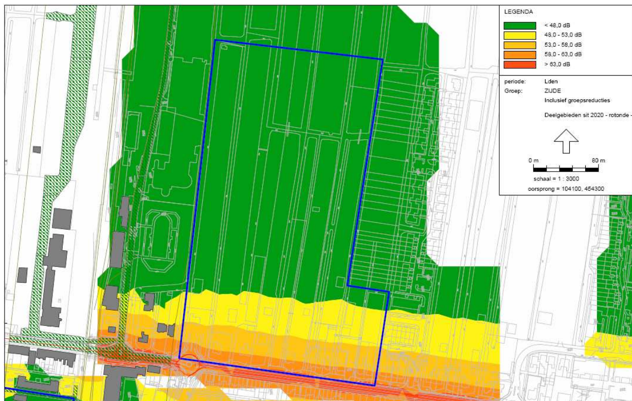
figuur 10: wegverkeerslawaai tengevolge van Zijde
