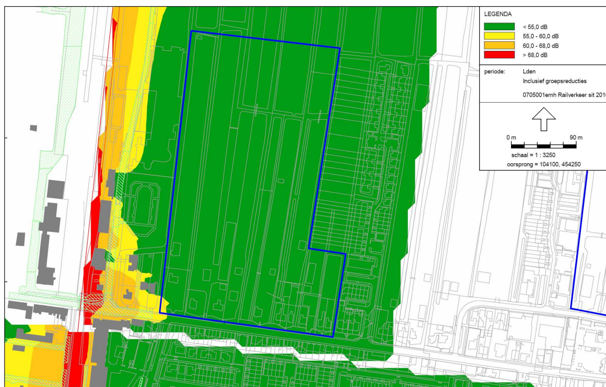
figuur 11: contouren spoorweglawaai met betrekking tot Torenpad west.
