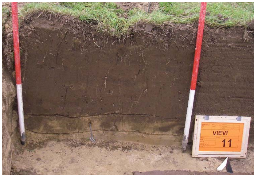
Afb. 4 en 5: Profiel 1.4 (boven) en 2.2 (onder). Profiel 1.4 laat een scherpe grens zien tussen de bouwvoor en de C-horizont. Bij profiel 2.2 is uitloging zichtbaar.
