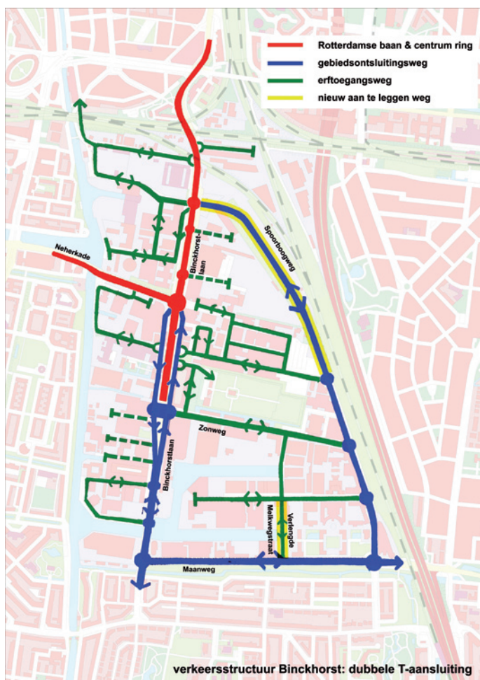
figuur 5.6 Schets T-aansluiting en aansluiting Verlengde Regulusweg via de nieuwe 'Spoorboogweg' op de Binckhorstlaan
