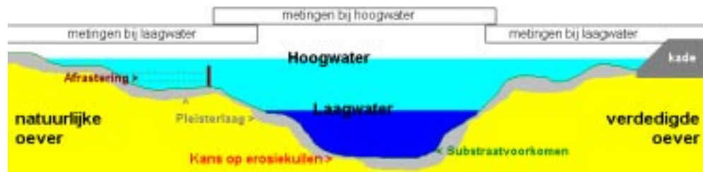
Figuur 1 Scenario 2 bodemprofiel: "hoog-, laagwater scenario"
