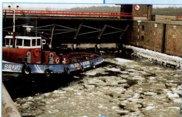
Door voor de sluisdeur te gaan liggen houdt een sleepboot het drijfijls weg bij een hefdeur.
