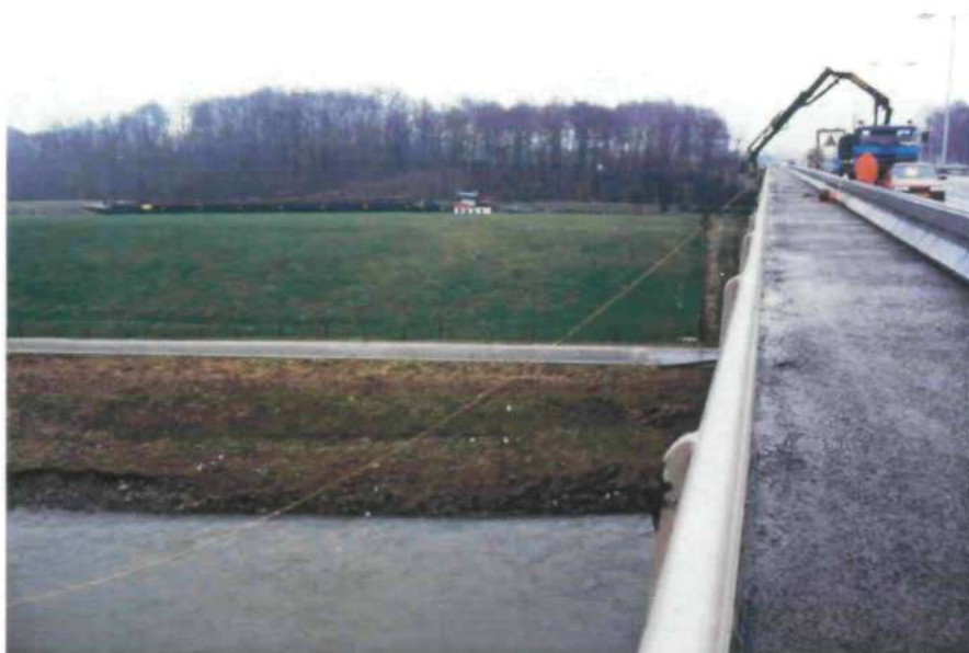
Foto 4.5 Bodemtransportmeting vanaf brug Stein/Elsloo (A76) met Julianakanaal (bovenaan) en Grensmaas. Rechts zicht op fietspad en vrachtauto op de vluchtstrook
