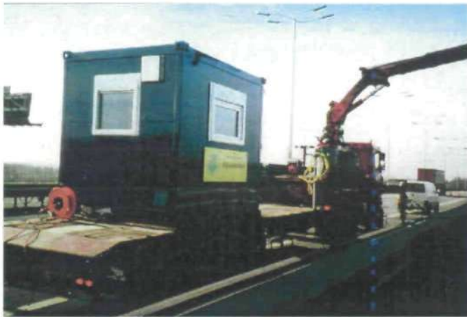
Foto 3.1 Meetcontainer BTMA-2 op dieplader met lier op brug Stein/Elsloo (A76)
