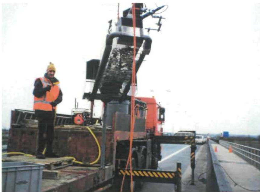
Foto 4.6 BTMA-2 hangend in de lierdraad in de standaard. De lierdraad wordt gevierd, de BTMA-2 kantelt en het sediment rolt in een opvangbak. Sinds 1995 wordt deze vrachtwagen gebruikt.
