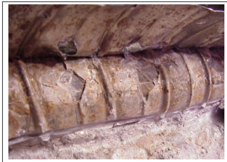
Figuur 4.3 Opegevouwen omhullingsbuis (zichtbaar aan de bovenzijde van de foto) en groutvulling (contramal van de omhullingsbuis afgetekend in grout)
