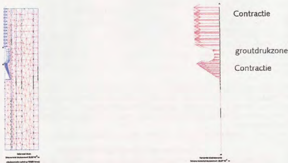
Figuur 8.3. Gedeformeerde axiaal-symmetrische mesh met opgelegde randvoorwaarden (links) en de verplaatsingen vlak boven de kruin van de tunnel (rechts)
