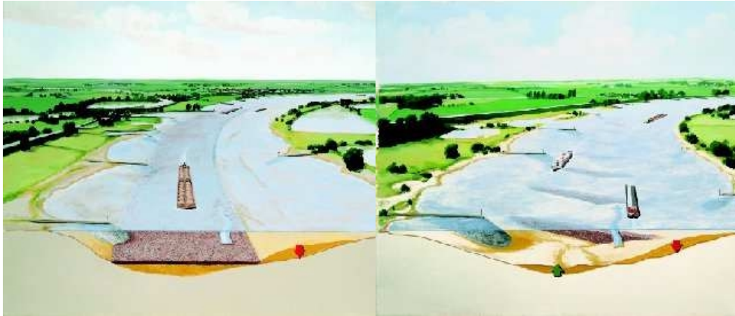
Figuur 3.2 Schets van de maatregelen “vaste laag” (links) en “bodembribben” (rechts) (illustratie K. Nuyten)
