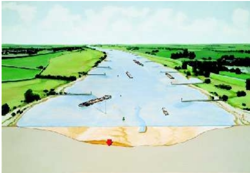
Figuur 4.1 Schematische weergave van baggerwerkzaamheden in een binnenbocht
