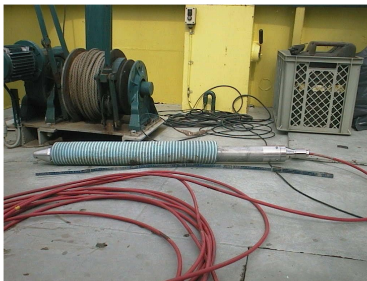
Figuur 1: De MEDUSA detector in een gedeelte van de blauwe PVC buis.
