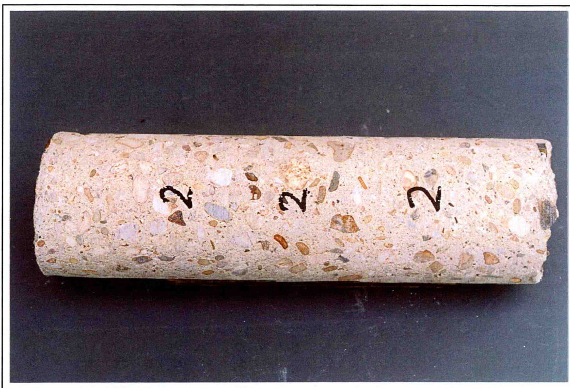
Boorkern 2. Kolkwand, noordzijde, ca. 3 m van de kolkvloer.
