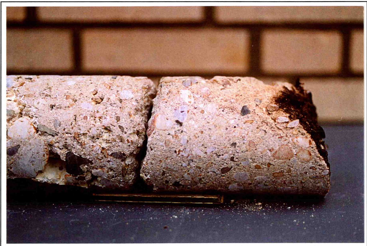
Boorkern 6. Kolkwand, zuidzijde bij oostelijke trap, 4 m van de kolkvloer.
