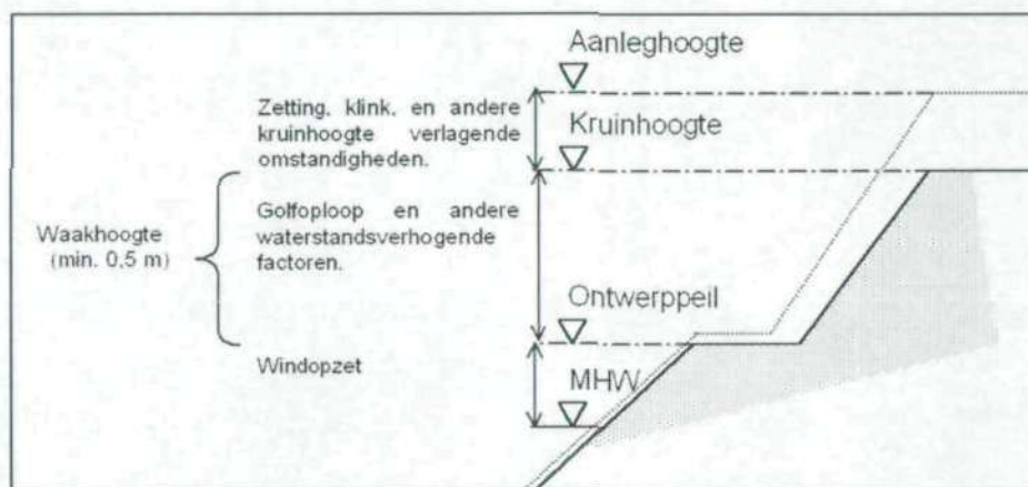
Figuur 2.4 Deterministische bepaling van de kruinhoogte van een dijk
