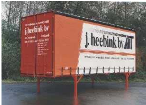
Figuur 2.3: wissellaadbak op "poten"
