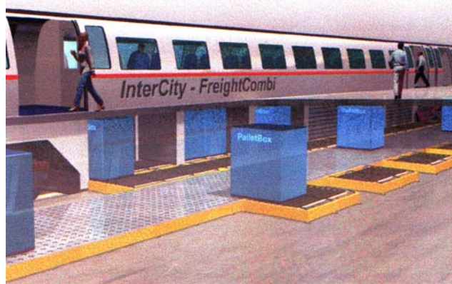
Figuur II.8: Schets van een Gecombineerd Rijtuig voor reizigers- en goederenvervoer
