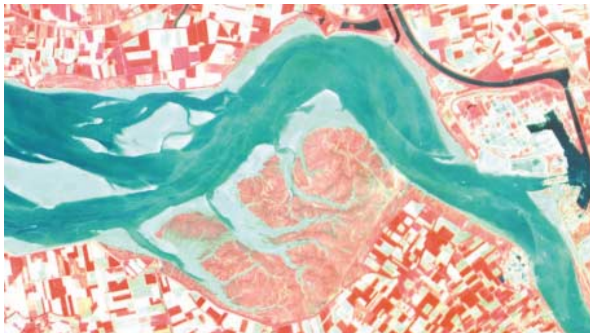
Remote sensing-informatie geeft een gedetailleerd ruimtelijk overzicht. In deze opname van de Westerschelde tussen Terneuzen en Antwerpen is duidelijk te zien hoe vanuit het Belgische deel van de Schelde hoge concentraties zwevend stof de Westerschelde in gevoerd worden.
