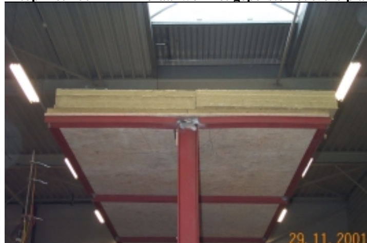
T-top met 200 mm mineraal wol met geperste houtvezelplaten
