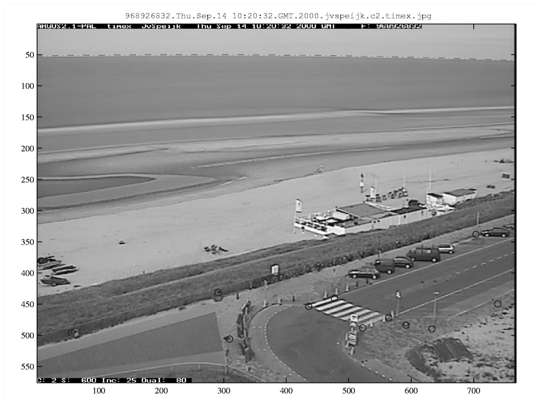
Figuur 4: handmatig bepaalde geometrie-oplossing voor 14 september 2000 (gebaseerd op een beeld van 11 augustus 2000). Camera c2, Jan van Speijk.
