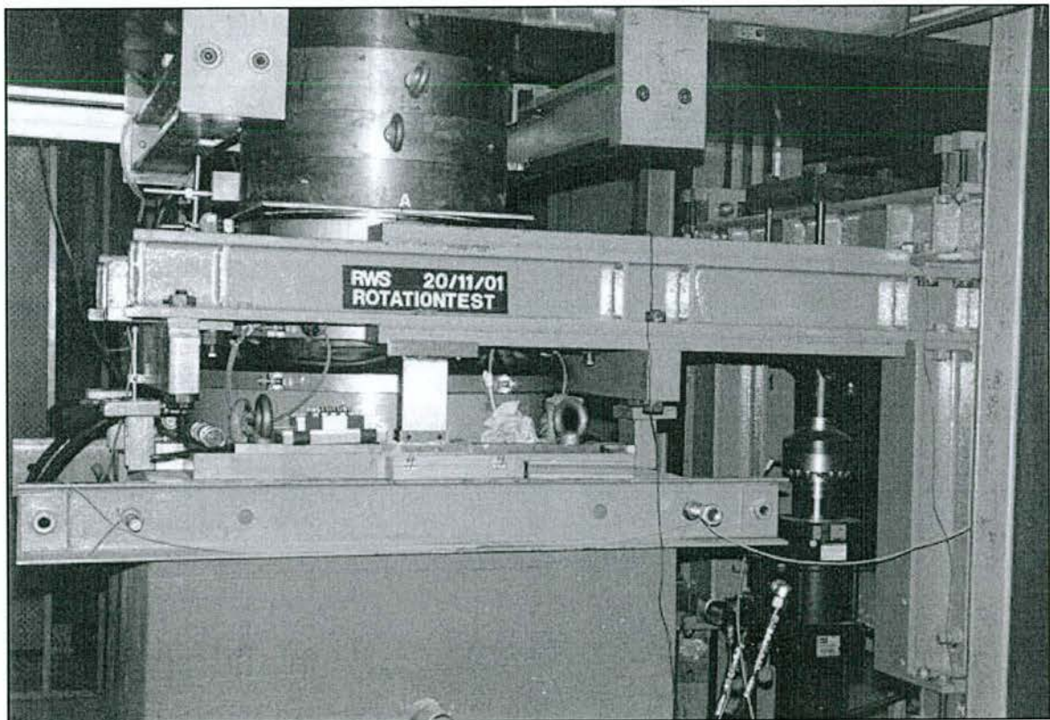
Abb. 3.2: Kippversuchstand mit eingebautem Topflager
