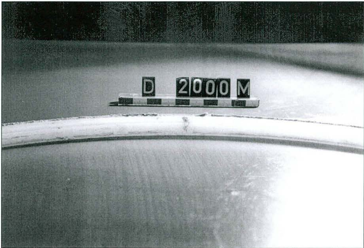
Abb. 5.22: UHMWPE-Innendichtung nach dem 2000 m-Verschleißversuch (Stelle D, in Kipp- richtung)
