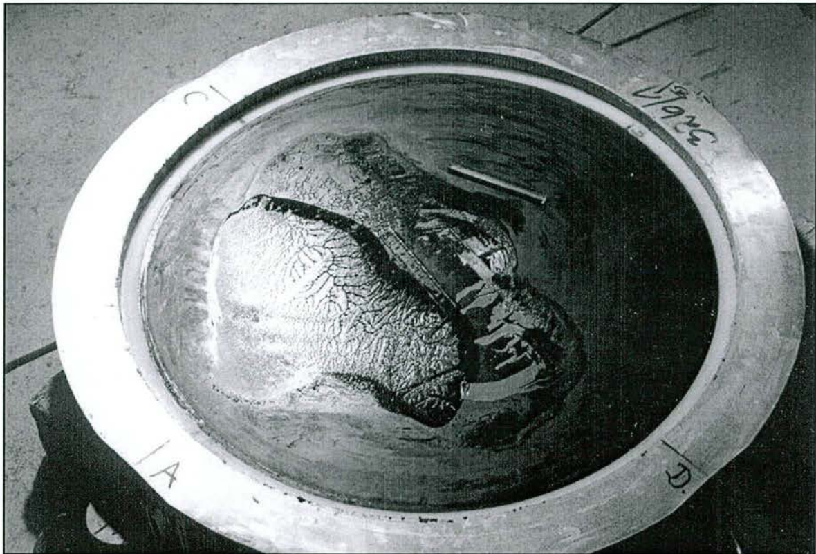
Abb. 5.9: Geöffnetes Topflager nach dem 2000 m-Verschleißversuch (Kippachse A-B)
