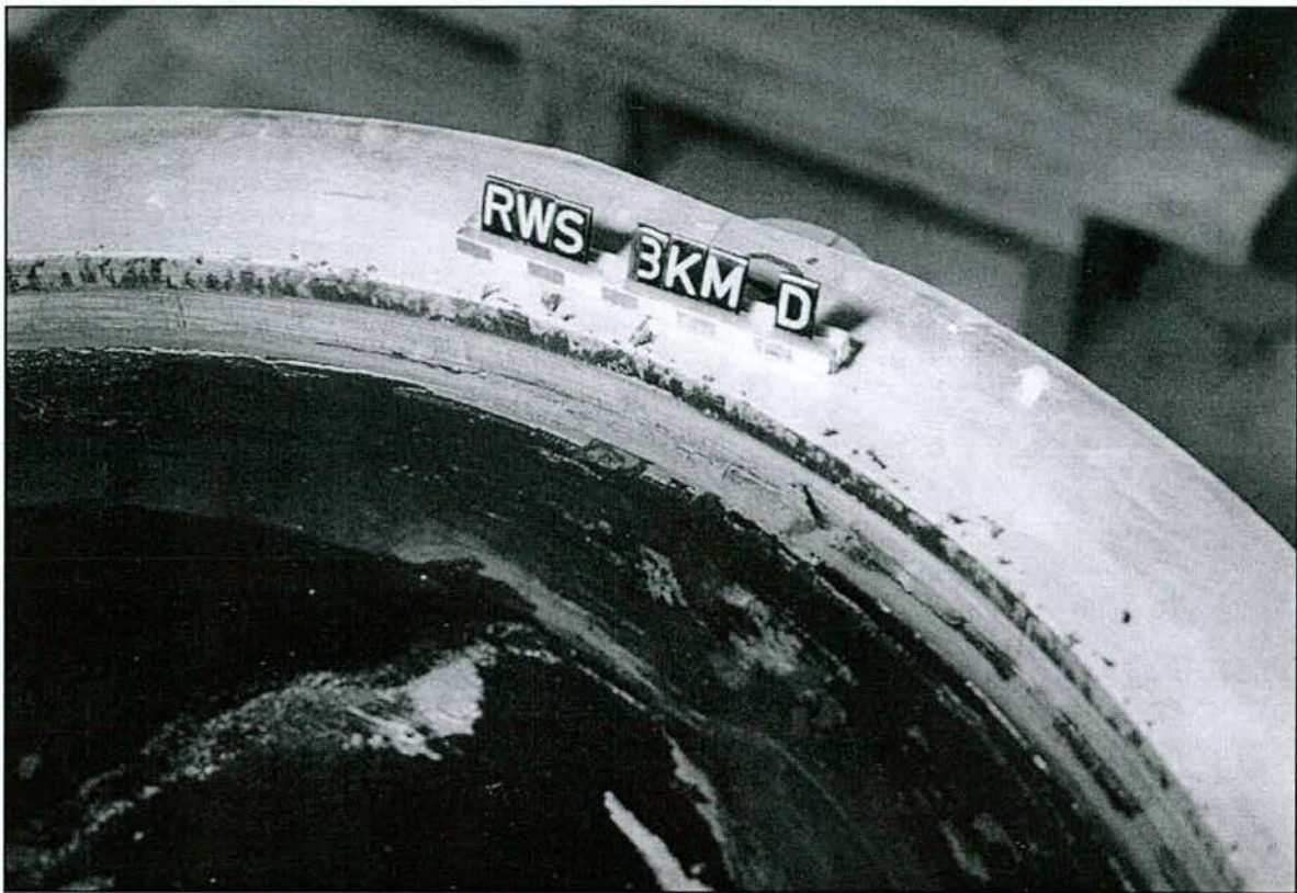
Abb. 9.11: Topf mit Elastomerkissen an der Stelle D (in Kipprichtung) nach Ausbau der UHMWPE-Innendichtung
