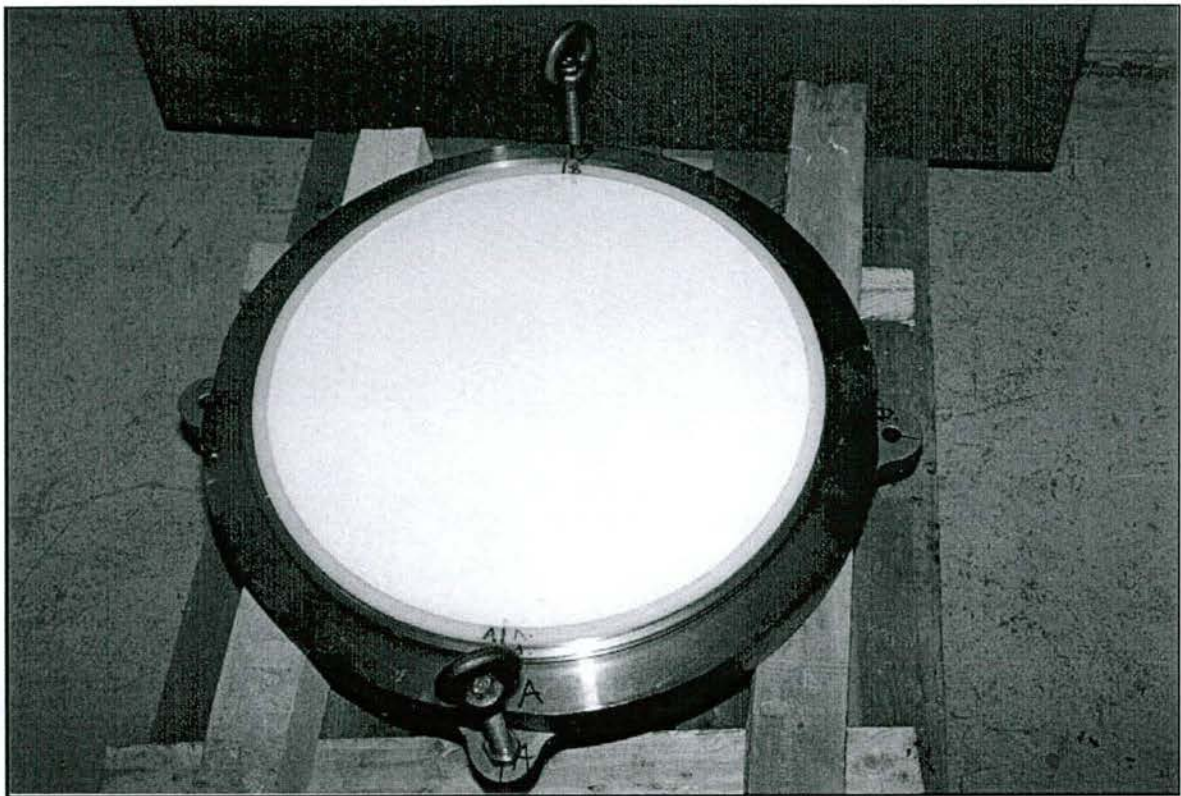
Abb. 2.3: Geschmiertes Gleitteil des zusammengebauten Topflagers: Deckel mit eingebauter PTFE-Platte und eingelegtem UHMWPE-Verstärkungsring
