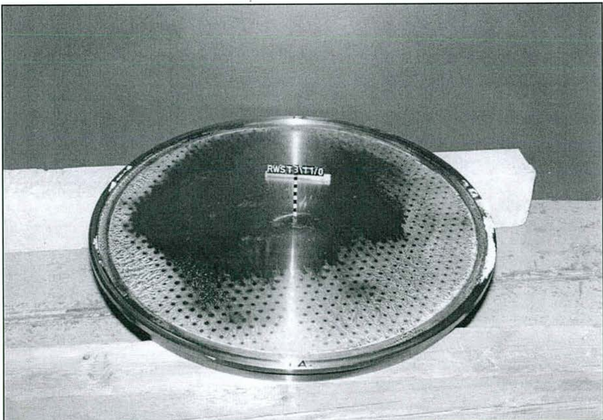
Abb. 4.3: Deckeloberseite nach Ausbau der PTFE-Platte und des UHMWPE-Verstärkungs-rings nach den Kippversuchen am ungeschmierten Topflager
