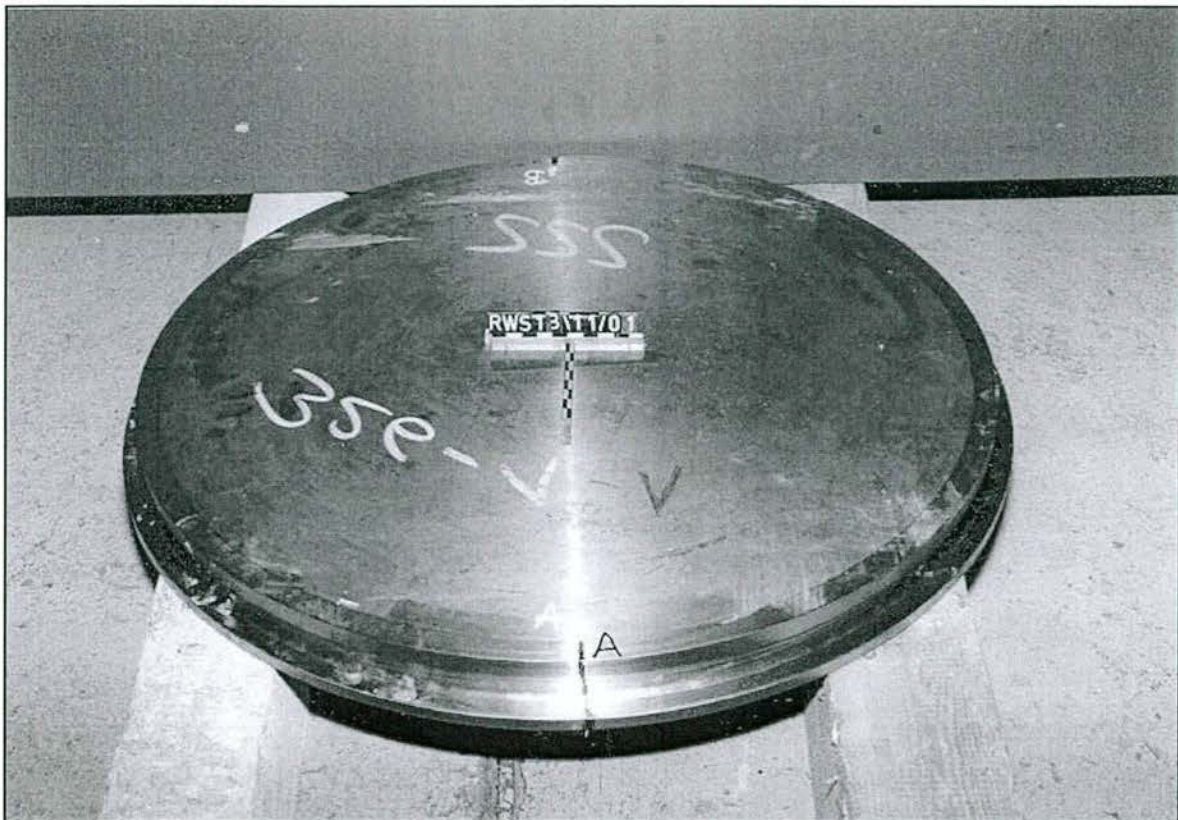
Abb. 4.4: Deckelunterseite nach den Kippversuchen am ungeschmierten Topflager
