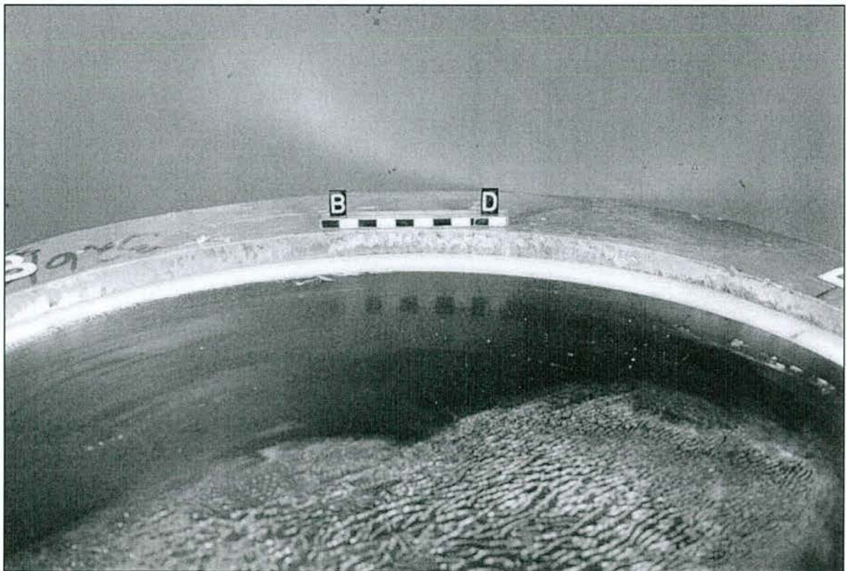
Abb. 6.19: Topfwand, UHMWPE-Innendichtung und Elastomerkissen im Bereich B-D
