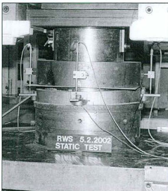
Abb. 6.2: Versuchsaufbau für den statischen Langzeit-Belastungsversuch (Foto links: Ansicht von vorne (Stelle A); Foto rechts: Seitenansicht (Stelle D))
