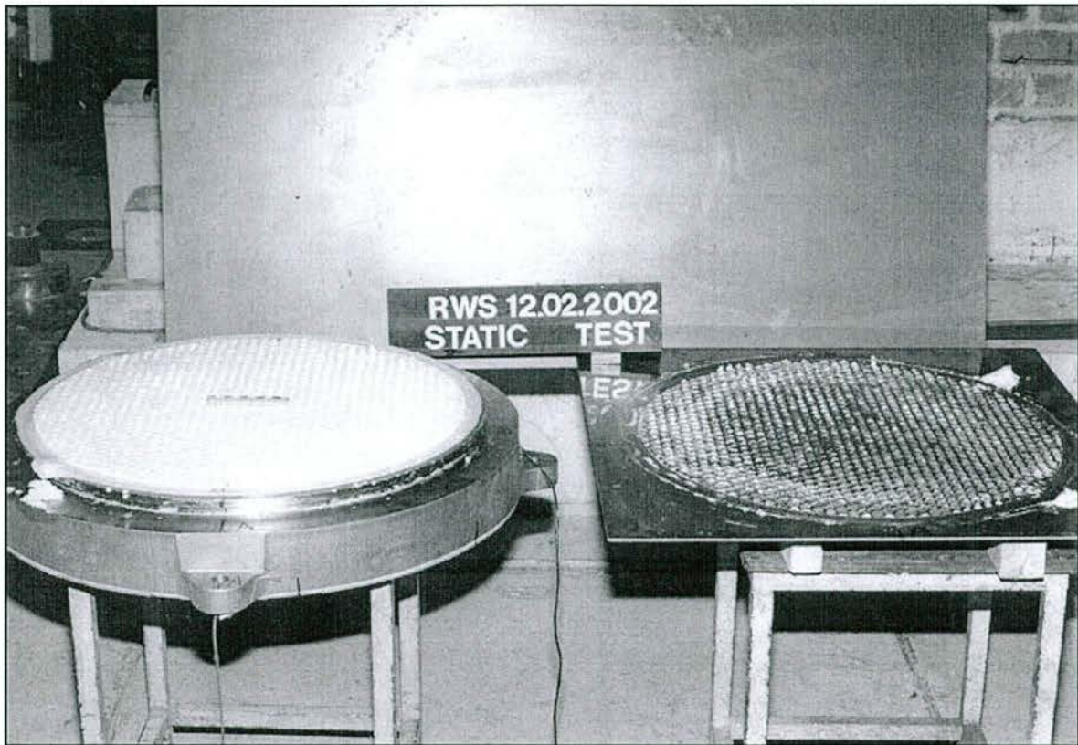
Abb. 6.12: Geöffnetes Gleitlager nach dem statischen Langzeit-Belastungsversuch
