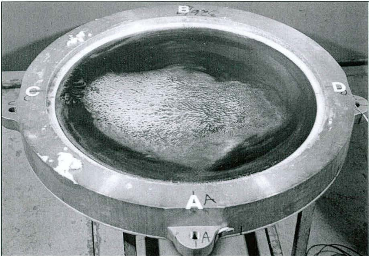
Abb. 6.18: Geöffnetes Topflager nach dem statischen Langzeit-Belastungsversuch
