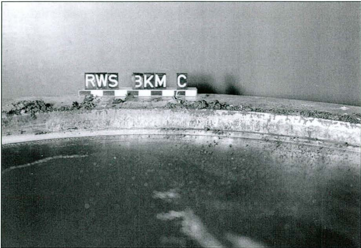
Abb. 9.7: Topf mit Elastomerkissen und UHMWPE-Innendichtung an der Stelle C (in Kipp- richtung)
