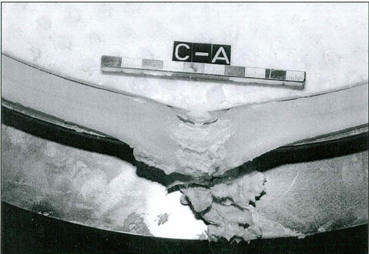
Abb. 6.15: Erster Defekt am UHMWPE-Verstärkungsring des Gleitlagers im Bereich A-C (Detailaufnahme)
