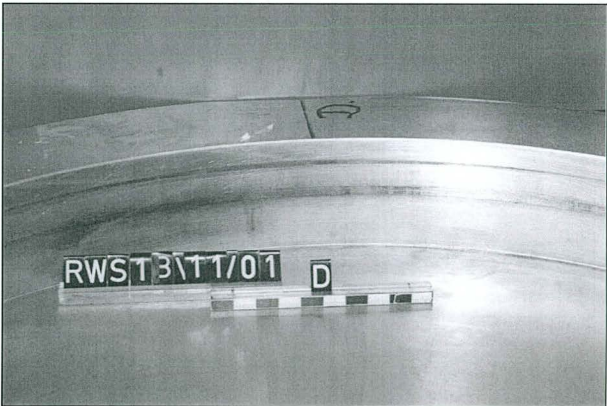
Abb. 4.10: Topfwandinnenseite nach den Kippversuchen am ungeschmierten Topflager (Stelle D)
