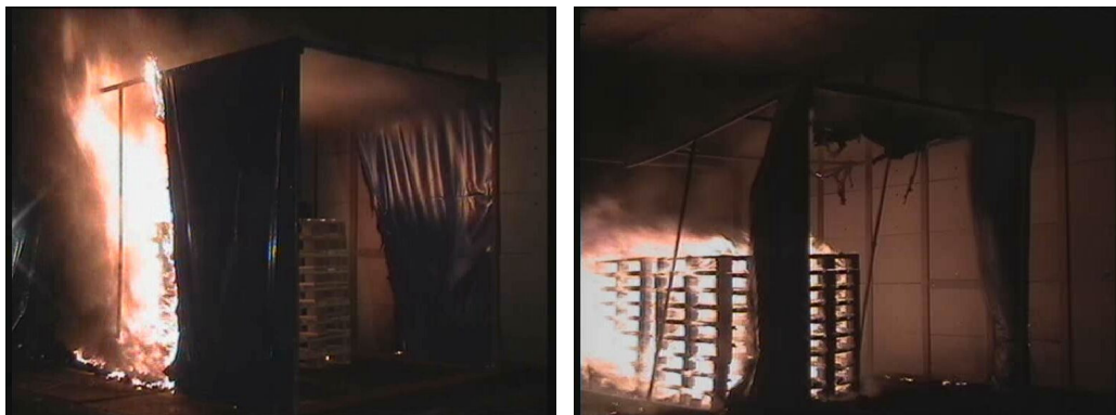
Figuur 11.5 De brandontwikkeling met en zonder ventilatie.
