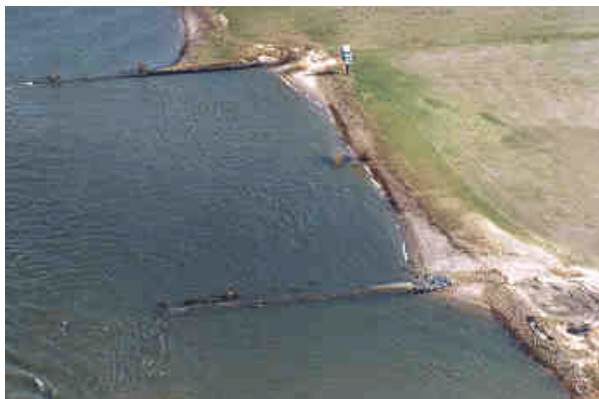
Figuur 3.10-a Herstel van achterloopse krib (Druuten, Waal km 907, Meetkundige Dienst 1995).
