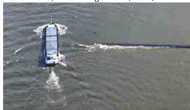
Fig. 2.3-d Vrije stroming over de krib, geforceerd door scheepspassage (Waal km 901, Meetkundige Dienst, 1995)
