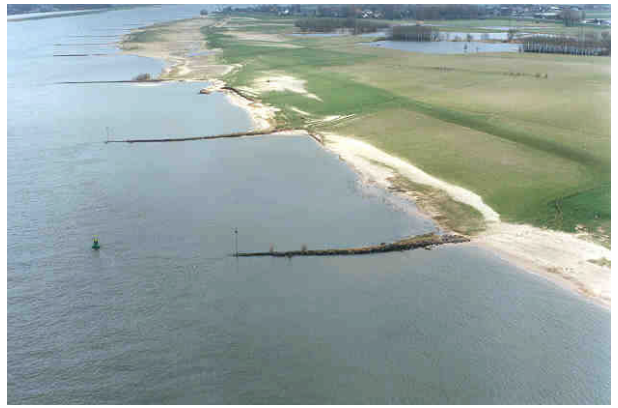
Fig. 2.1-d Stroomgeleiding, (Broomwaard, Waal km 940, Meetkundige Dienst, 1995)
