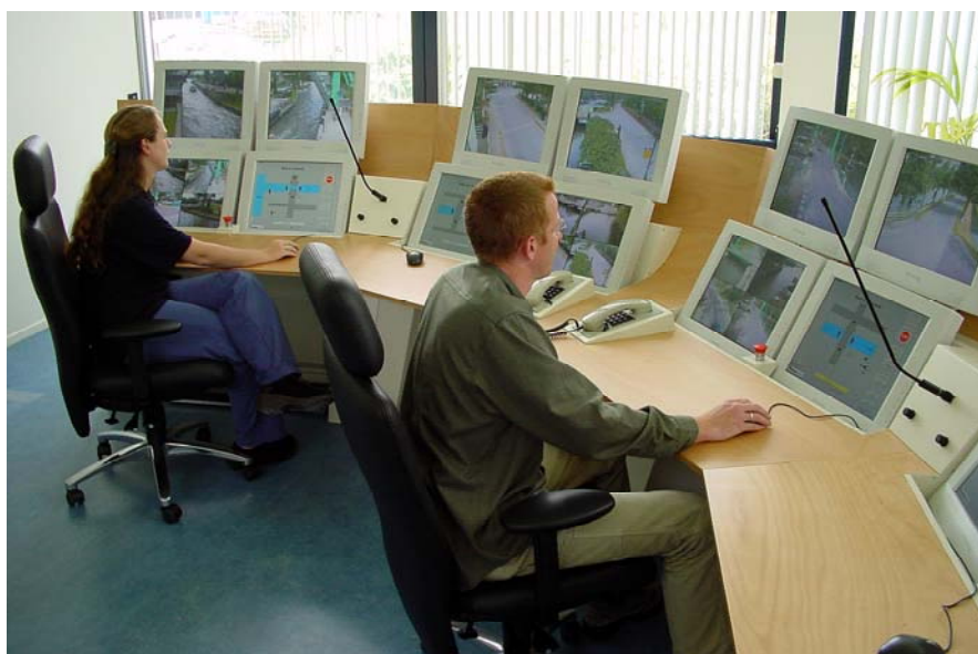
Figuur 5. In deze figuur worden 2 geschakelde duo-werkplekken getoond in de terminal-uitvoering van figuur 4. Per duo-werkplek is centraal een (eenvoudige) communicatie-unit gepositioneerd.
