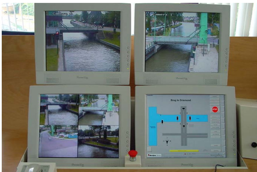
Figuur 4. In de figuur wordt een bedienterminal getoond volgens het multi-split concept, waarbij 3 monitoren de ondersteuning van de videobeelden verzorgen. Dit is dus een halve duo-werkplek.
