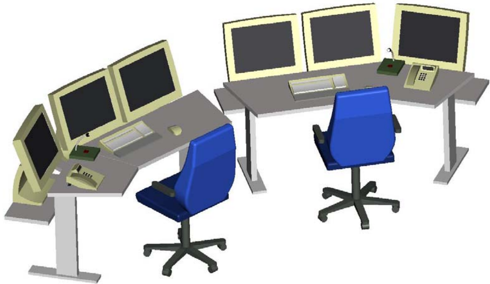
Figuur 3. In de figuur worden twee geschakelde moderne compacte duo-werkplekken getoond, voor twee bedienaren maar zonodig ook door één bedienaar goed te gebruiken .
