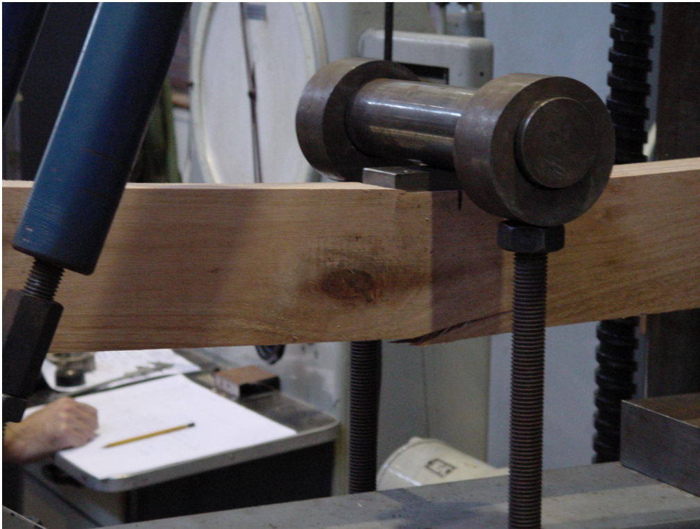
Figuur 3: Scheurvorming in de trekzone ter plaatse van de belasting ten gevolge van draadverloop om een kwast in een vijfpuntsbuigproef, houtsoort karri.
