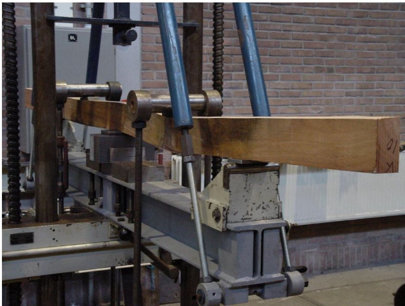
Figuur 6: Balk belast in vijfpuntsbuigproef
