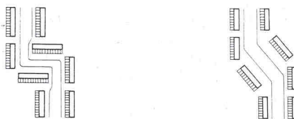
Grote asverspringing (met versmalde verkeersruimte) en kleine asverspringing ter beperking van de snelheid van het autoverkeer
