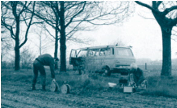
Figuur C.2 De voorbereidingen voor een geo-elektrisch onderzoek: het uitleggen van de kabels voor de elektrodes.
