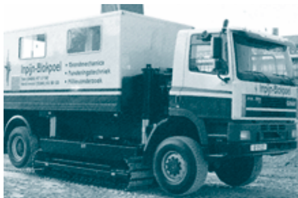
Figuur B.10 Een van de aanpassingen die mogelijk zijn om ook op slecht begaanbare terreinen te kunnen sonderen: een sondeerwagen met extra rupsonderstel.
