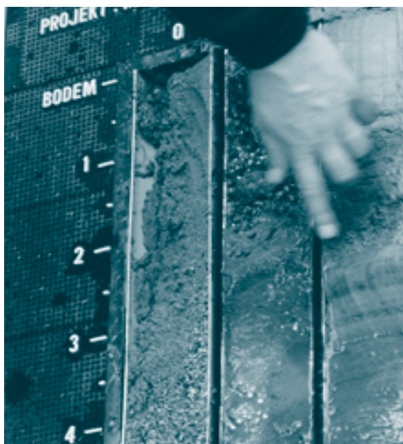
Figuur 2.2 Voorbeeld van het beeld dat een gestoken boring van de bodemlagen geeft. Op de foto is te zien dat de bovenste laag bestaat uit grof zand met grindige lagen. Daaronder zit fijnkorreliger sediment met dunne donkere kleilaagjes.
