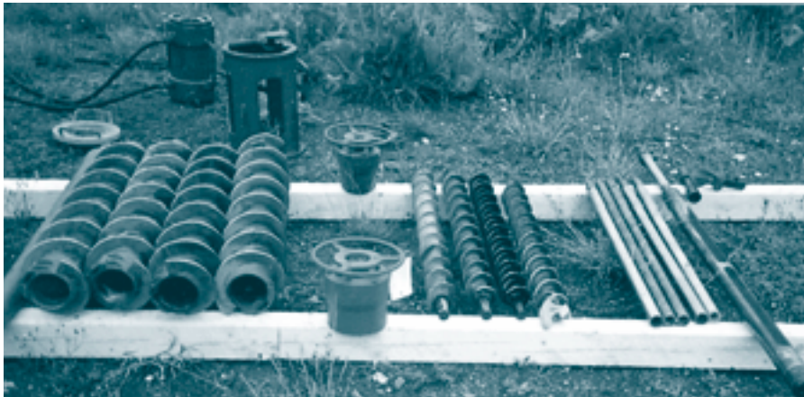
Figuur B.5 Overzicht van holle avegaar boren met verschillende diameters.
