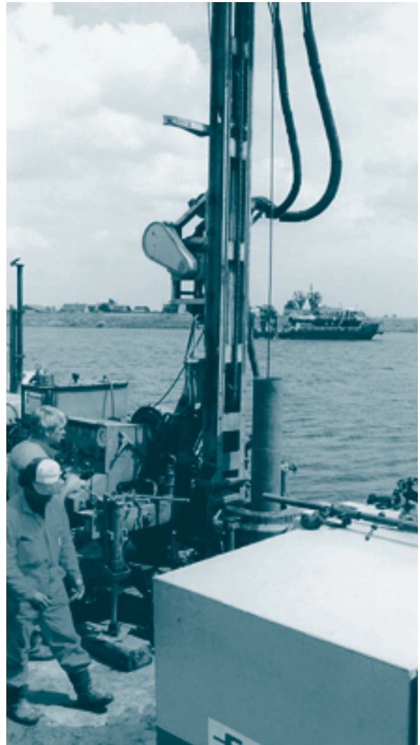
Figuur 4.7 Boorponton met boorstelling voor grondonderzoek van waterbodems.
