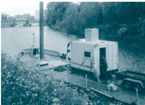
Figuur B.11 Een sondering op water die vanaf een ponton wordt uitgevoerd.
