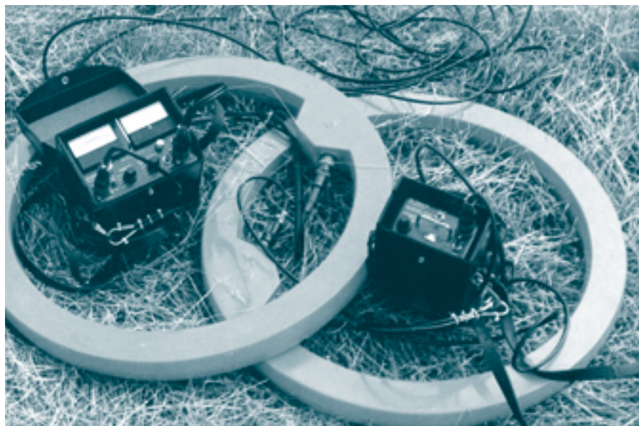
Figuur C.3 De meetspoelen die gebruikt wordt bij een elektromagnetische meting met EM-38 meetapparatuur.
