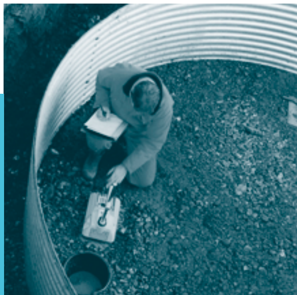
Figuur 7.1 Dichtheidsbepaling van het toutvenant door in-situ met een Troxler apparaat de dichtheid van het toutvenant te bepalen. Na afloop van het grondonderzoek bleek verificatie van de te hanteren omrekenfactoren van volume naar massa toutvenant noodzakelijk.
