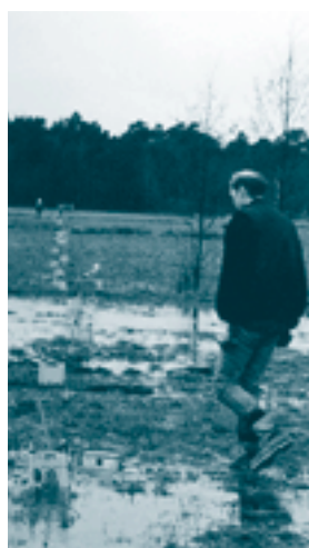
Figuur 4.6 Geofysisch veldwerk: opname van een seismisch profiel. Hiertoe worden geluidsontvangers (geofoons) op regelmatige afstanden geplaatst. Met een geluidsbron of springlading worden trillingen uitgezonden. De opnemers registreren de terugkaatsing van geluidsgolven op verschillende laagovergangen in de ondergrond.
