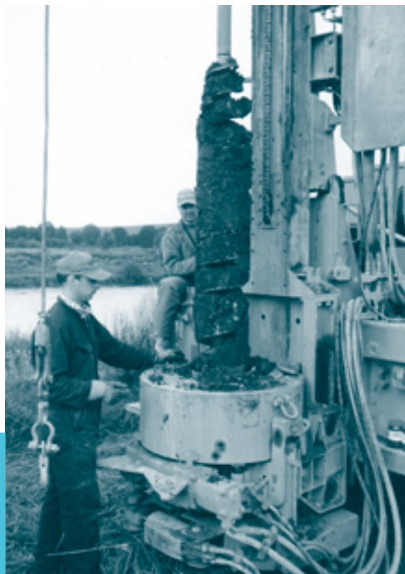
Figuur B.8 Het monster bij de holle avegaar zit in de spoed van de spiraal. De boren zijn in verschillende diameters te krijgen.
