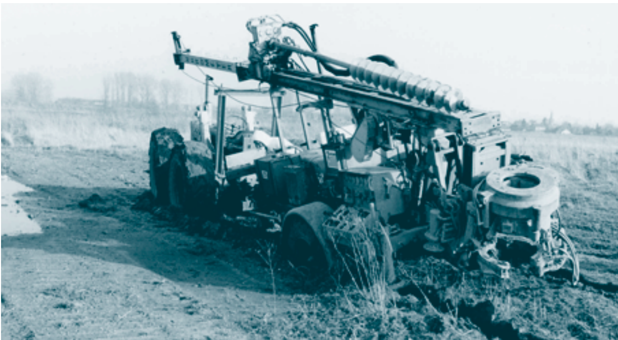
Figuur 4.1 Het seizoen kan de doorlooptijd van veldwerkzaamheden sterk beïnvloeden: een drassige bodem bemoeilijkt de verplaatsing van een boorstelling tussen de boorlocaties.
