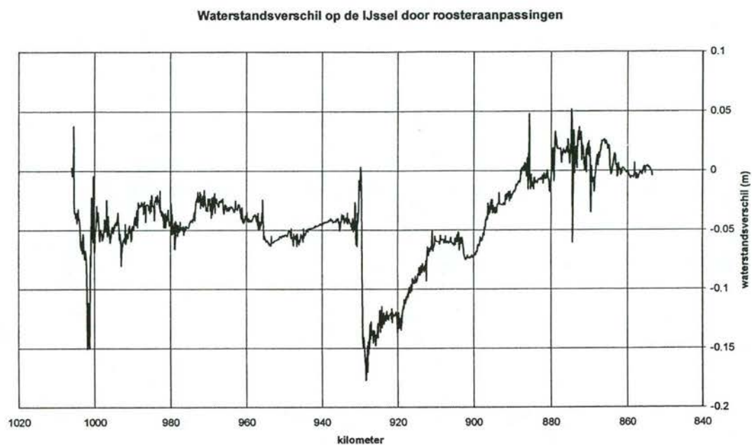
Figuur 4-8 Waterstandsverschillen op de IJssel door roosteraanpassingen bij 16.000 m 3 /s
