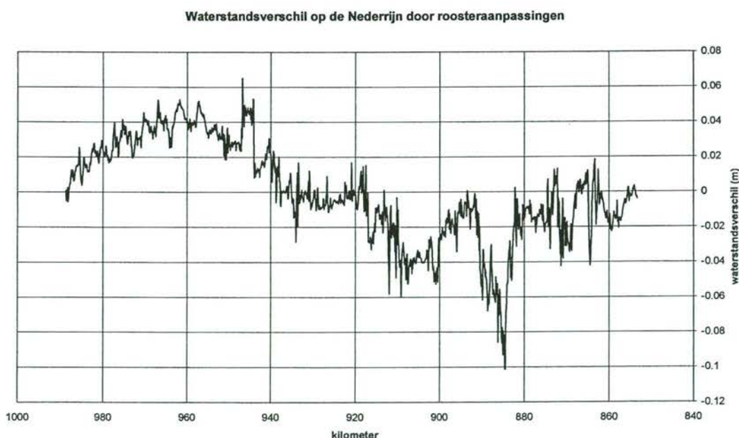
Figuur 4-7 Waterstandsverschillen op de Neder-Rijn door roosteraanpassingen bij 16.000 m 3 /s
