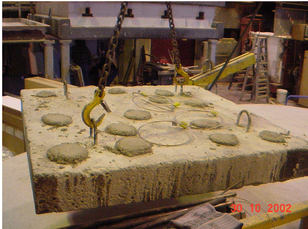
Foto 3: Betonplaat vanaf onverhitte zijde, na opvullen gaten en aanbrengen thermokoppels
