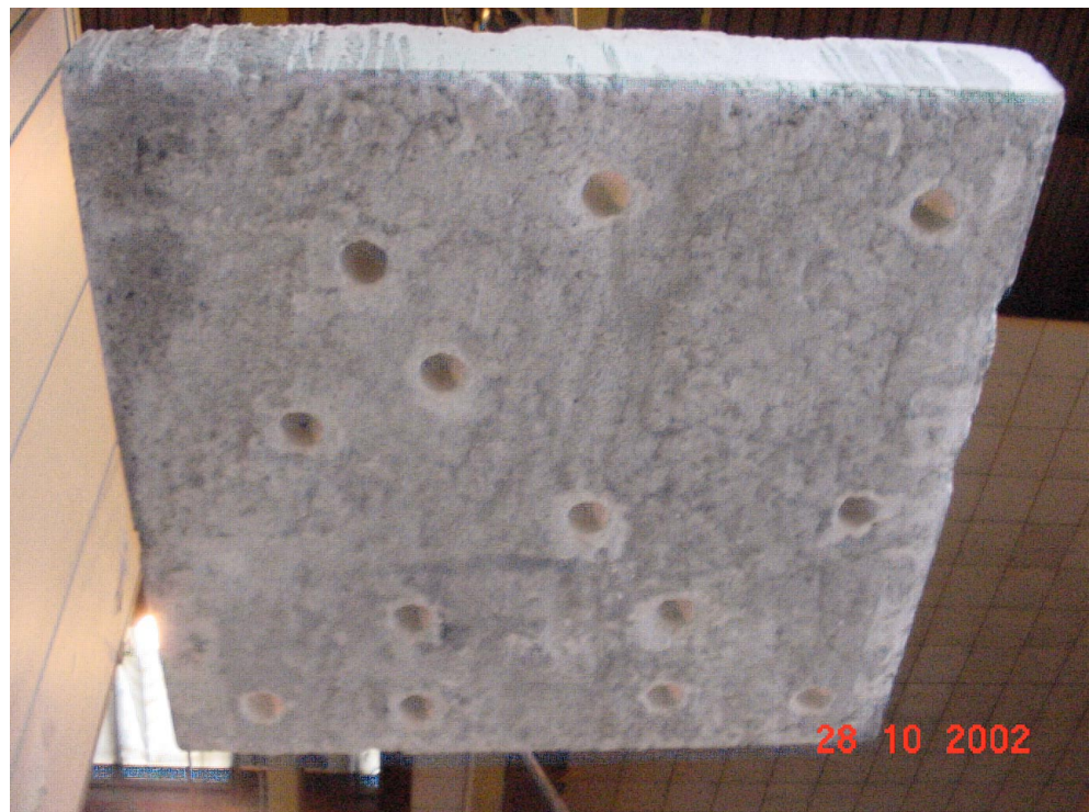
Foto 2: Betonplaat vanaf verhitte zijde na kernboringen
