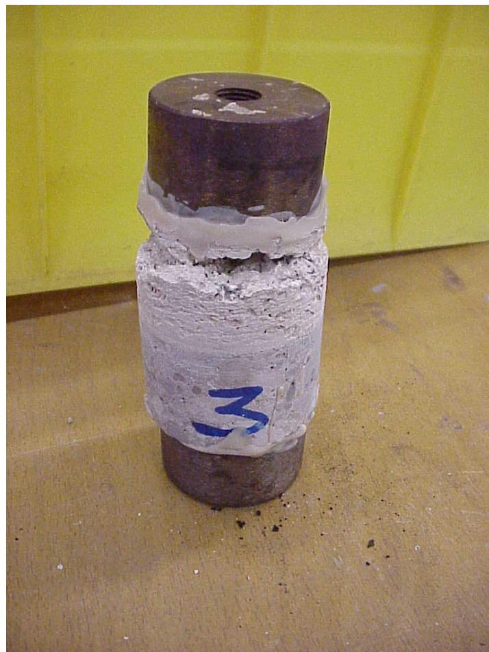
Foto 6: Geboorde cilinder nr. 3 na hechtsterkte bepaling
