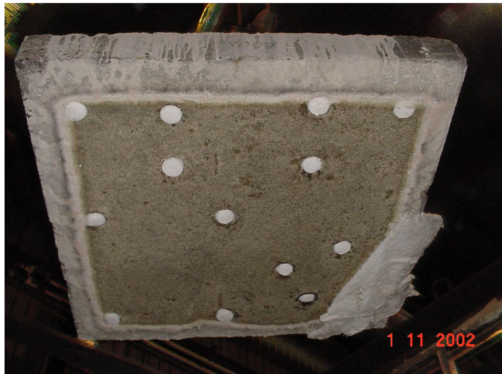
Foto 5: Betonplaat vanaf verhitte zijde na de brandproef
