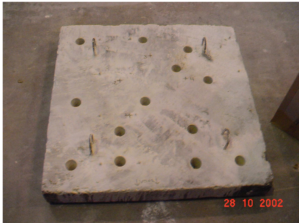
Foto 1: Betonplaat vanaf onverhitte zijde, na kernboringen, tevens locaties thermokoppels aangegeven
