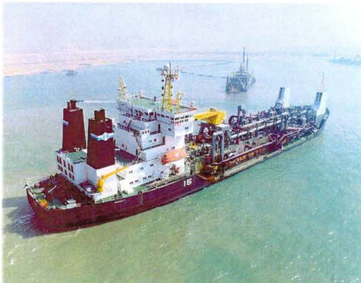
Abbildung 4-11: Beispiel für ein Großgerät: Hopperbagger
