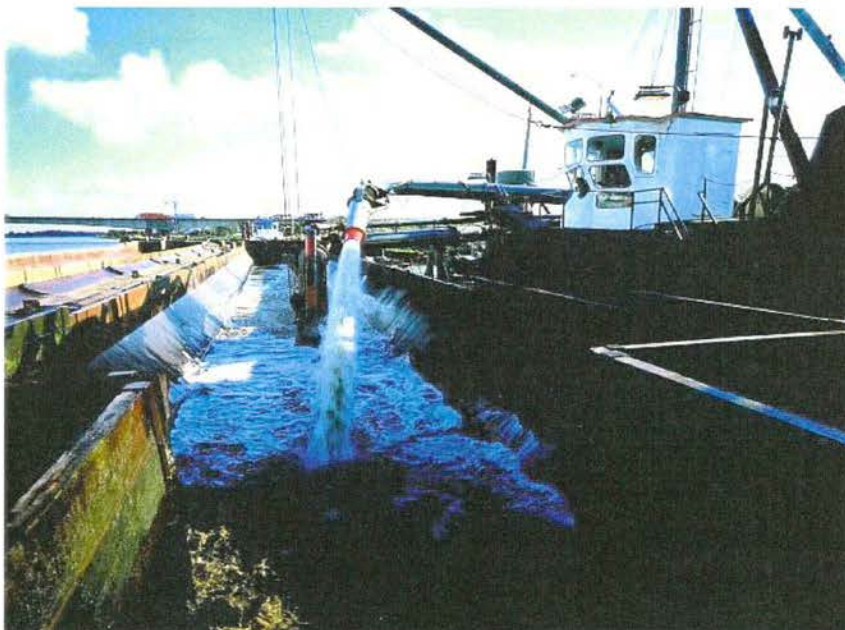
Abbildung 4-14: Schutensauger in Aktion
