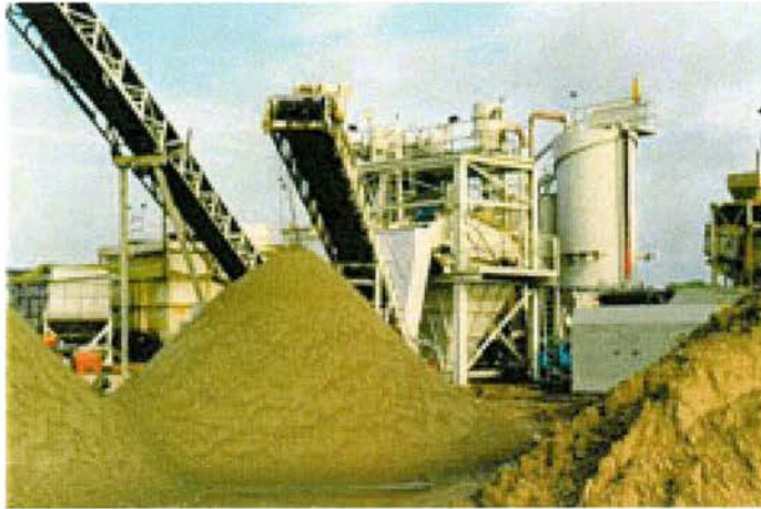
Abbildung 4-20: Mechanische Sandtrennung
