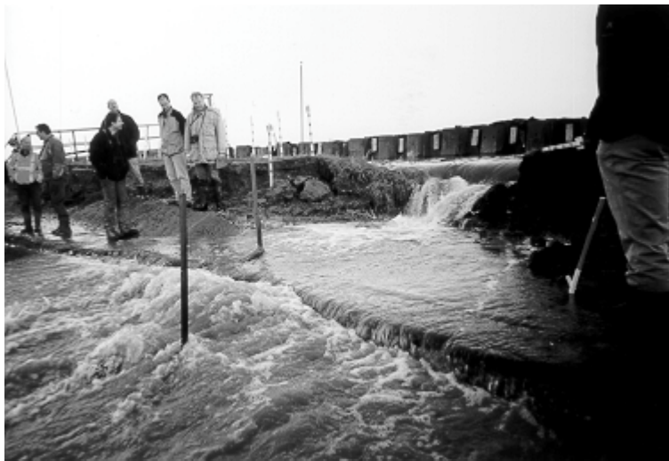
Figuur 7.2: Bres in tuimelkade, met stroming grotendeels onder de asfaltstrook door.
