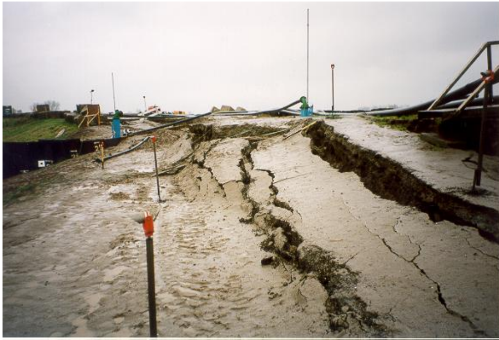
Detail scheurvorming in de kruin.
