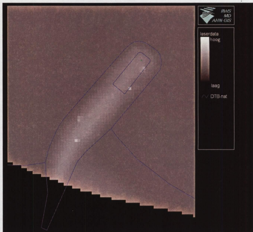
Figuur 6: Zowel de laseraltimetrie (grid van 1m bij 1m) als de DTB-nat (blauwe lijnen) van een krib bij rivierkilometer 939.605 in de Waal.
