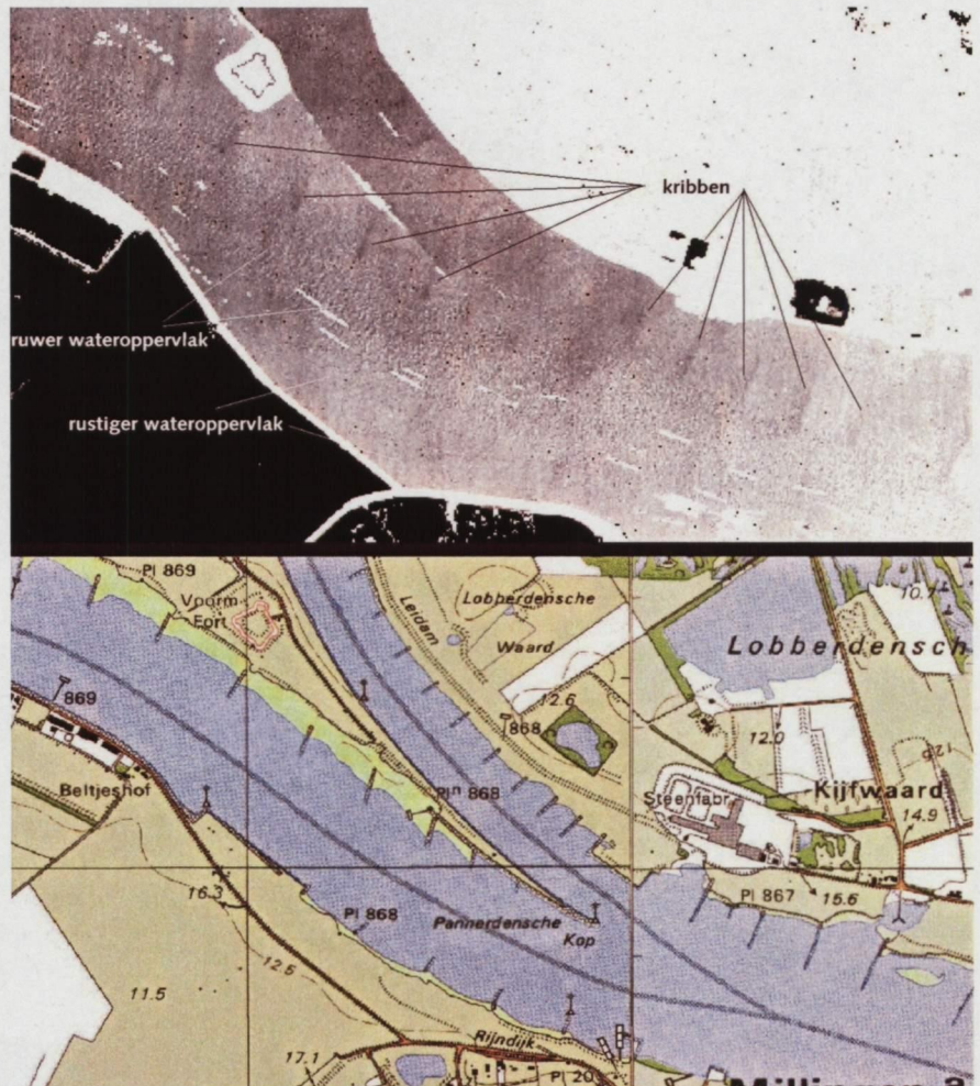
Figuur 10: Laserdata van de Pannerdensch Kop tijdens een hoogwatergolf in november van 1998. Ter vergelijking is het fragment uit de topografische kaart bijgevoegd. De kribben zijn zowel in het laser- als topografische beeld te zien.
