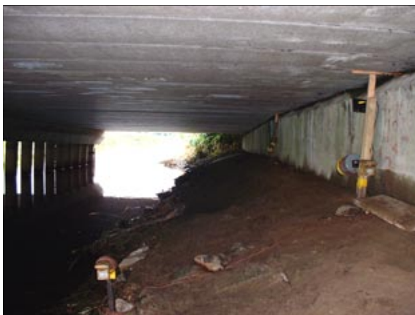
Figuur 3.19 Proefopstelling bij de Dommel, met schijnwerper en camera langs de wand.
