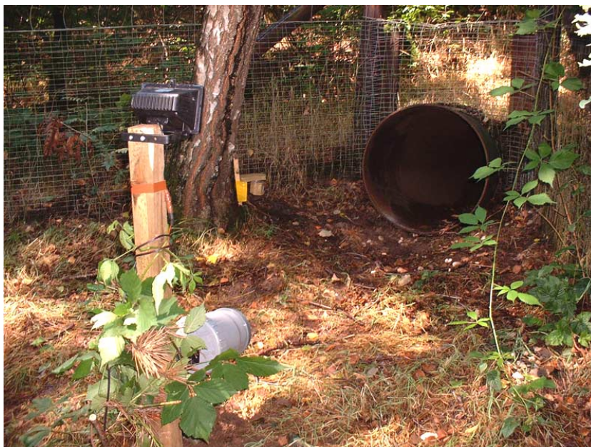
Figuur 3.26 Proefopstelling dassentunnel A50 Oosterhuizen, met schijnwerper boven op de paal met camera.
