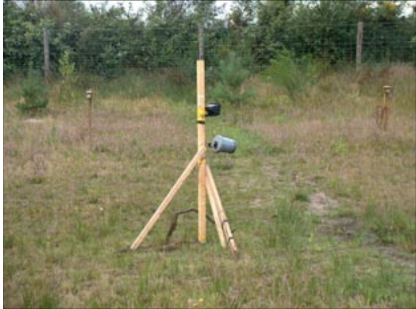
Figuur 3.15 Proefopstelling ecoduct, met extra schijnwerper op de paal met camera.
