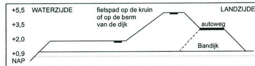
Figuur 5.2: Tuimeldijk aangelegd tegen het bestaande dijklichaam.
