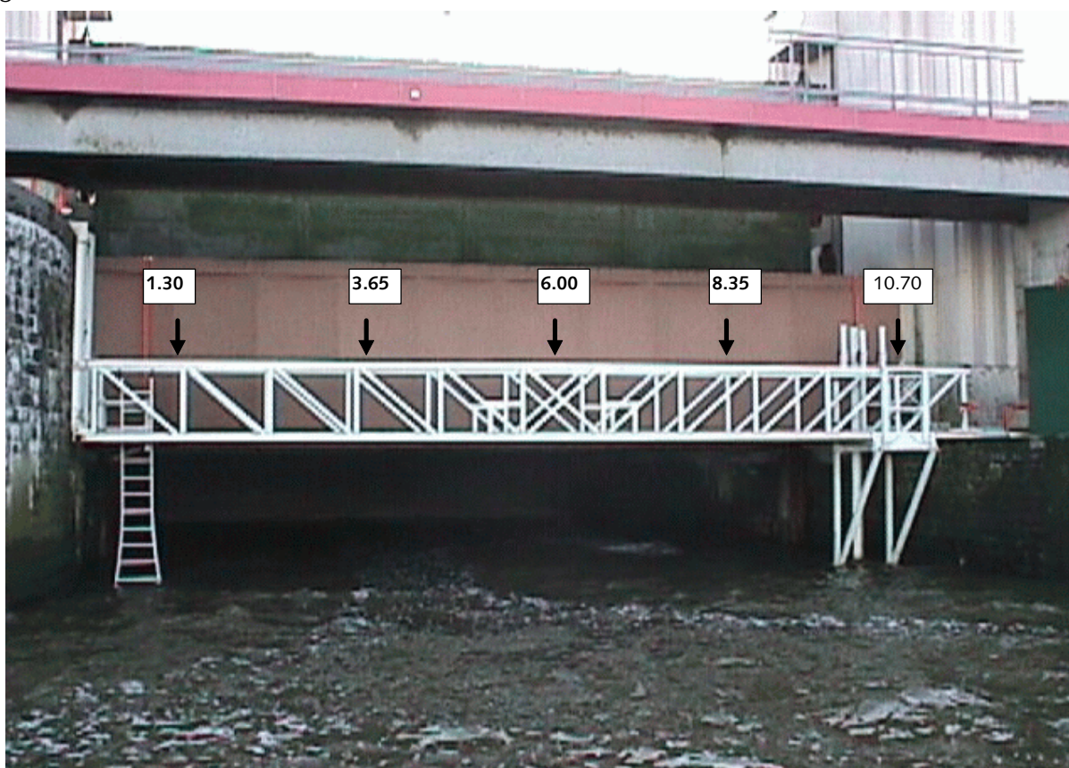
foto 2.1: Meetbrug thv koker 5 met de meetpunten.
