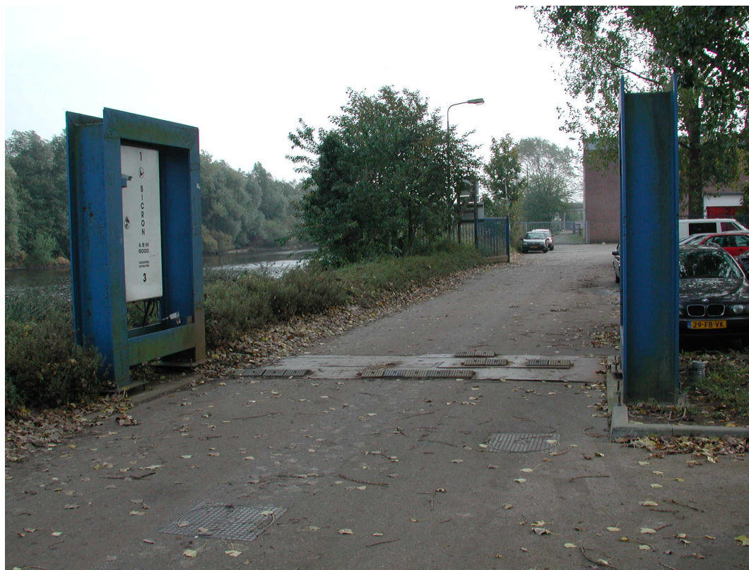
Figuur 1 Poortdetector van het type Bicron ASM 6000 III
