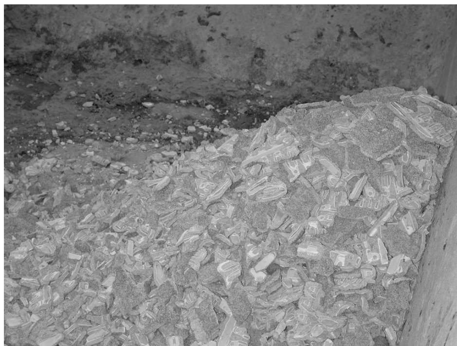
Figuur 1 Berg keramiekafval op bodem van container bij Cirex bv, Almelo. De typische afmeting van een brokje bedraagt enkele centimeters. De brokjes zijn afkomstig van een grotere structuur die als gietmal dienst heeft gedaan
