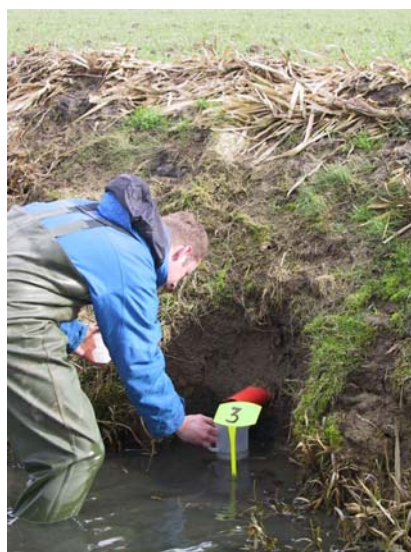
Figuur 2.3: Bemonstering van drainagewater ten behoeve van het MKBGL-klei
