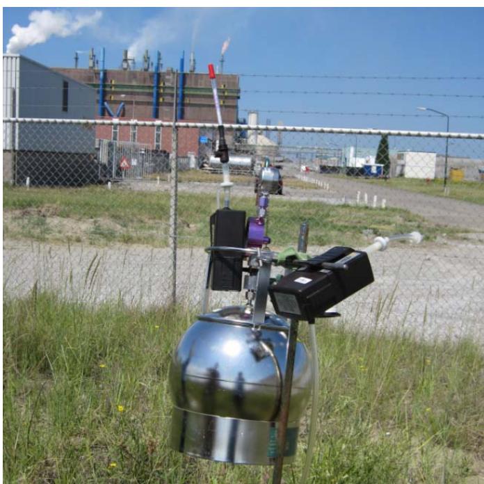
Figuur 18. Foto van een additionele bemonstering (locatie Ad2) Op de foto zijn een canister te zien en twee luchtpompjes, waarbij de ene is uitgerust met een aldehydecartidge en de andere met een buisje voor fosforzuurbemonstering.
