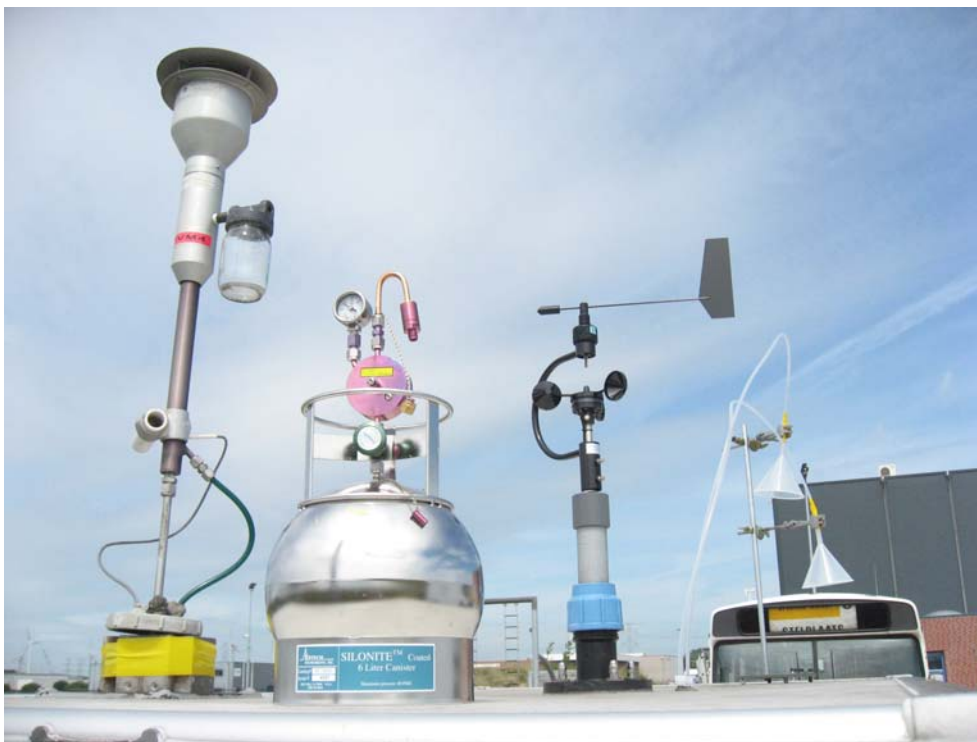
Figuur 27. Weerstation, aanzuigbuis en slangen en canister op aanhanger
