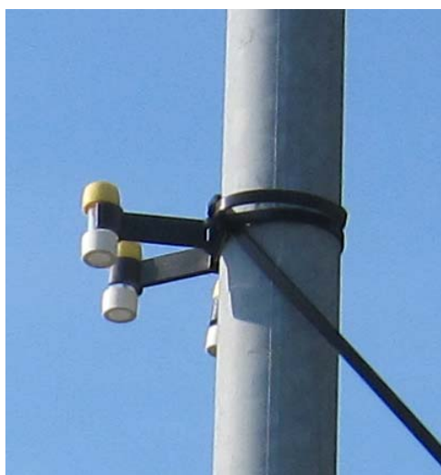
Figuur 24. Passieve ammoniak samplers
