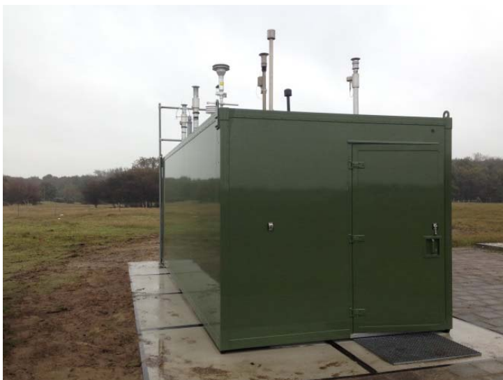
Figuur 4 Voorbeeld van een LML meetbehuizing
