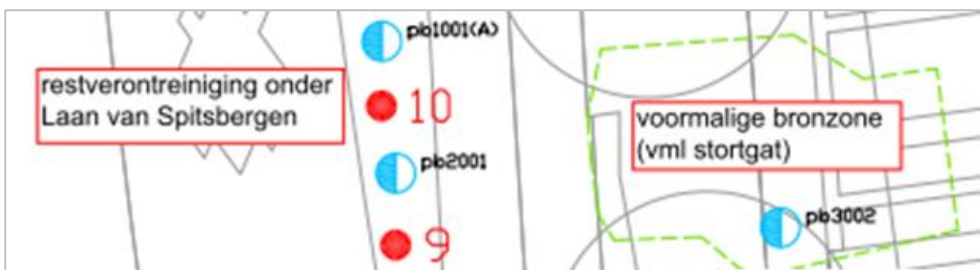
Afbeelding 4: Schets ligging voormalig brongebied dat is ontgraven (voormalig stortgat) en restverontreiniging onder Laan van Spitsbergen, met ligging saneringsfilters en monitoringspeilbuizen
