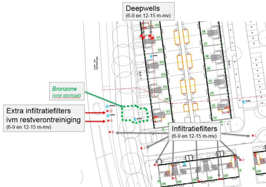
Afbeelding 2: Schets ligging in-situ saneringssysteem, inclusief extra infiltratiefilters ter plaatse van restverontreiniging Laan van Spitsbergen (filters nr. 9 en 10)
