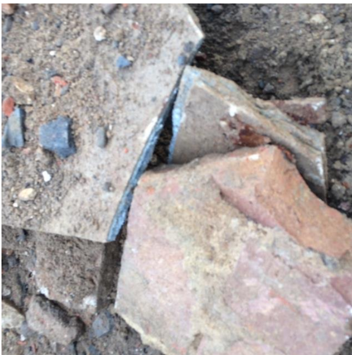
Foto 8: asbesthoudend plaatmateriaal uit puinpad
