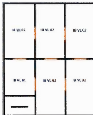
Schematische opbouw van een in te metselen kraamverblijfplaats; links onder de IB VL 01, de overige kasten (IB VL 02) worden gekoppeld geplaatst, na verwijdering van de in oranje aangegeven tussenschotjes.
