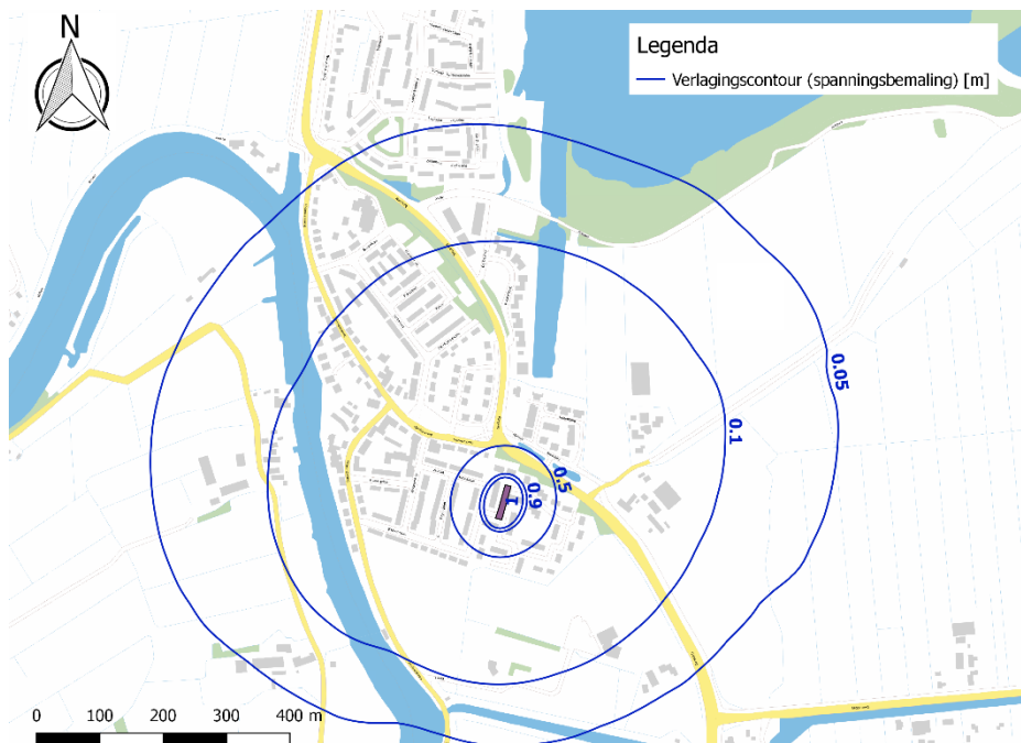
Figuur 5-6: grondwaterstandverlaging deelloccatie 3 (spanningsbemaling).
