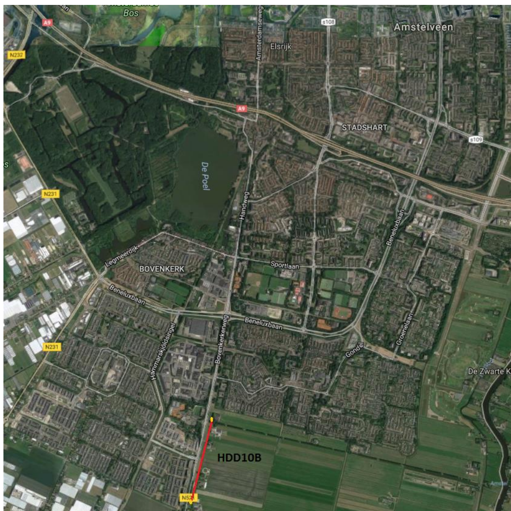
FIG01B: SCHEMATISCHE WEERGAVE OVERZICHT BORING (HDD10B)
