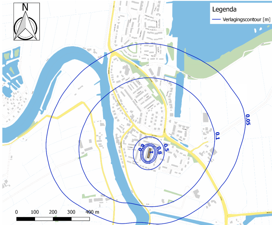
Figuur 5-5: grondwaterstandverlaging deelloccatie 2 (spanningsbemaling).
