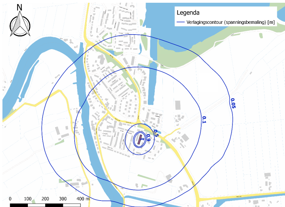
Figuur 5-6: grondwaterstandverlaging deelloccatie 3 (spanningsbemaling).
