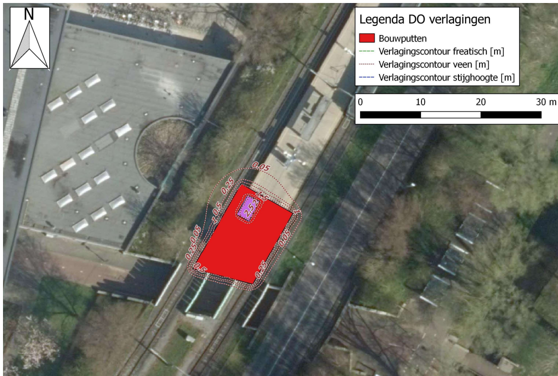
Figuur 37. Verlagscontour (Veen) halte Meent. In rood: bouwput en in paars: liftput
