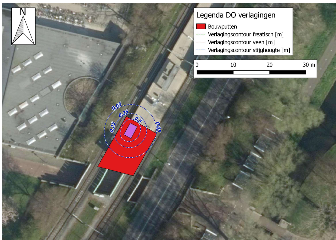
Figuur 38. Verlagscontour (stijghoogte, 1e WVP) halte Meent. In rood: bouwput en in paars: liftput.
