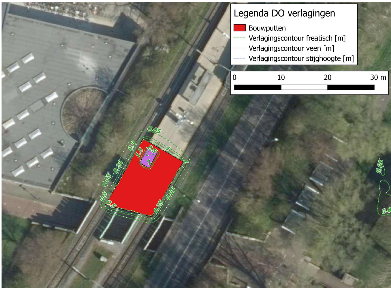
Figuur 36. Verlagsingscontour (Freatisch) halte Meent. In rood: bouwput en in paars: liftput.
