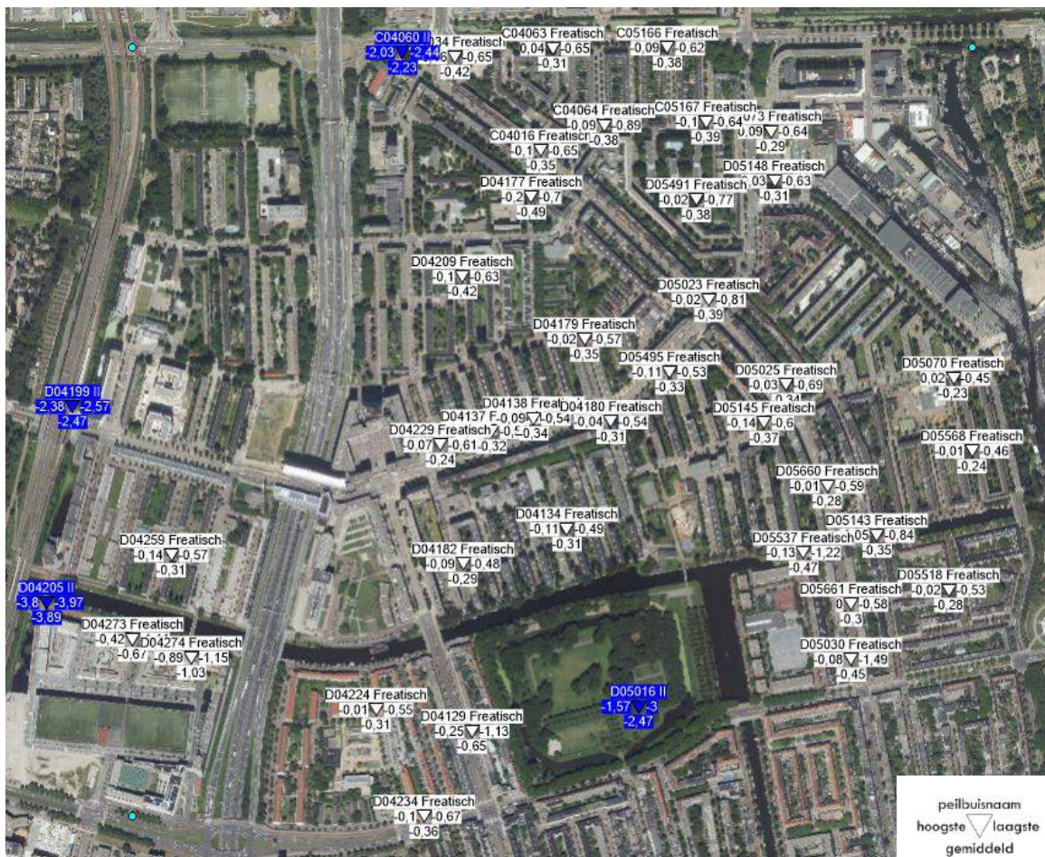
Figuur 2 - grondwaterstand t.o.v. NAP (wit = freatisch/watervoerende laag 1, blauw = watervoerende laag 2)
