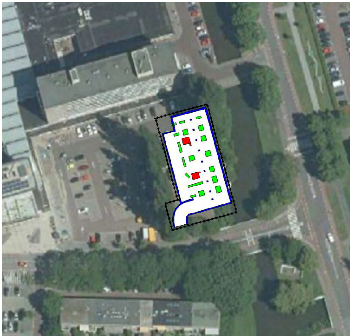
Figuur 1 – locatie kelder (wit), liftputten (rood) en damwanden (zwart)
