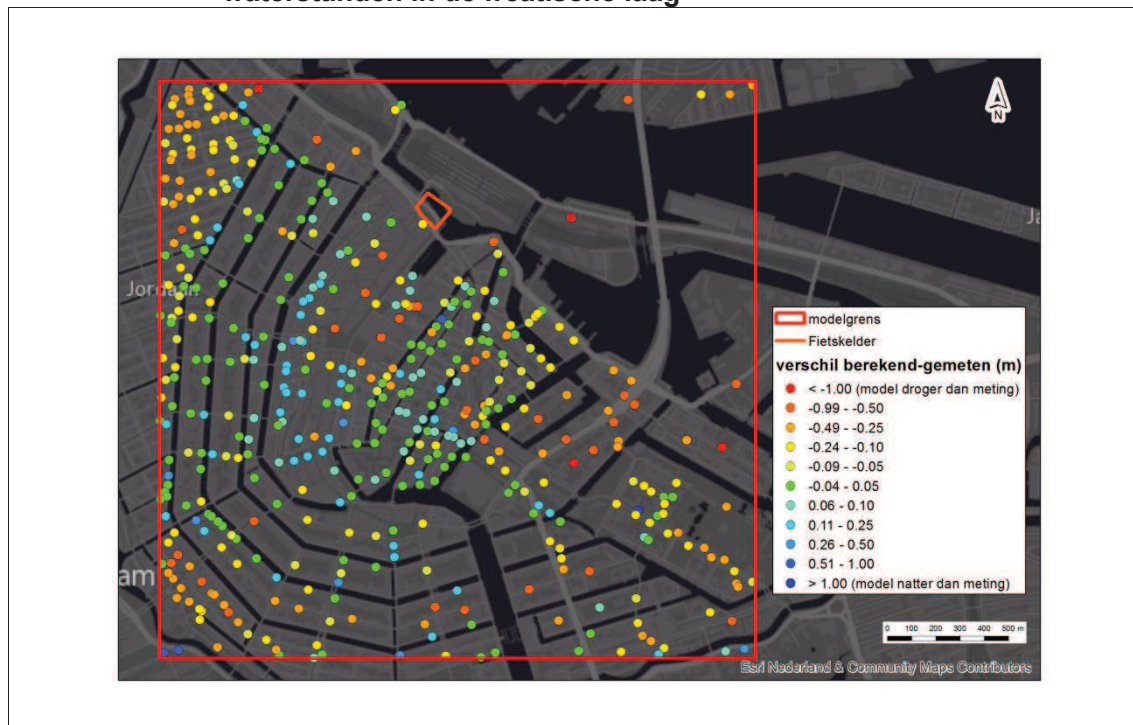
Afbeelding 3.8. Ruimtelijke verdeling verschil tussen berekende en gemeten grondwaterstanden in de freatische laag
