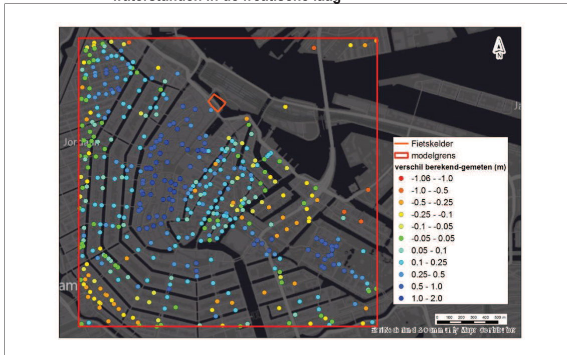
Afbeelding 3.7. Ruimtelijke verdeling verschil tussen berekende en gemeten grondwaterstanden in de freatische laag
