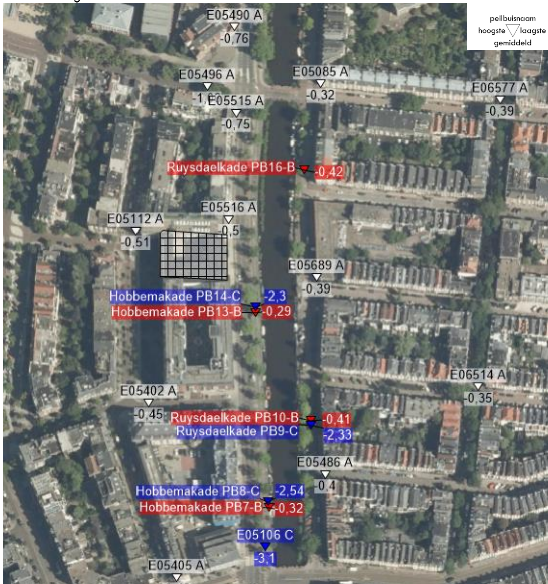
Figuur 2 - gemiddelde grondwaterstand t.o.v. NAP (wit = freatisch/watervoerende laag 1, rood = watervoerende laag 2 en blauw = watervoerende laag 3)
