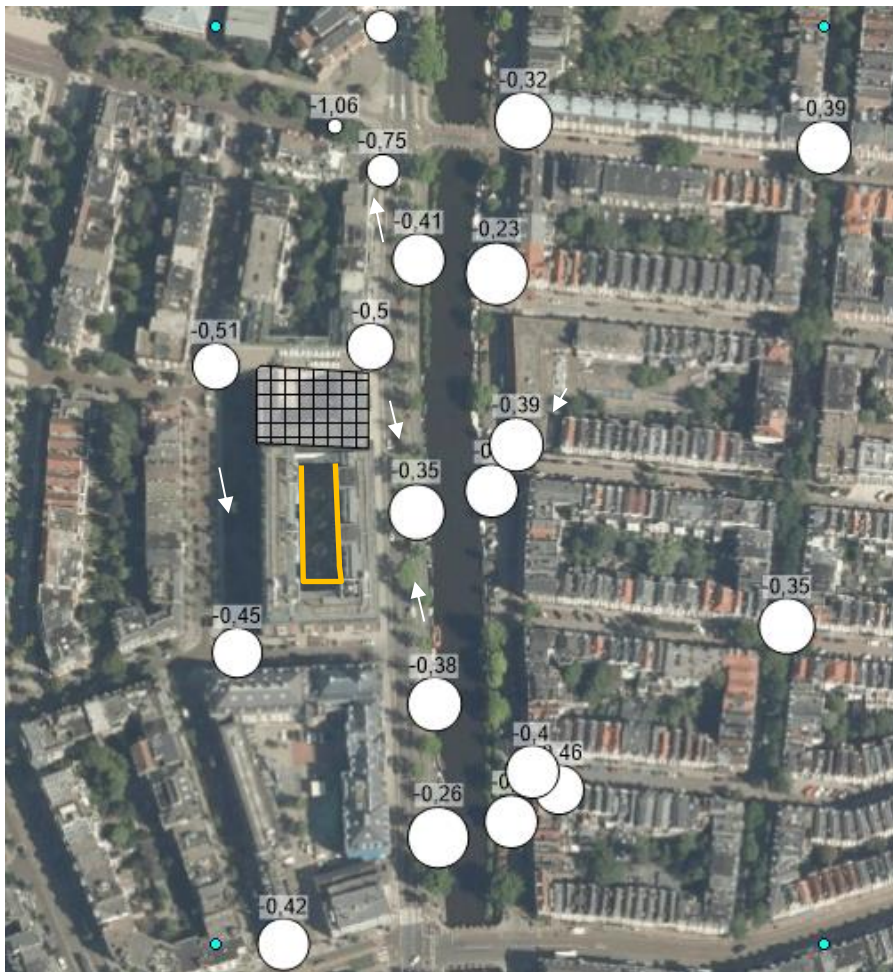
Figuur 6 - peilbuislocaties (omvang cirkel is de hoogte van de grondwaterstand, een grotere cirkel staat voor een hogere grondwaterstand). De peilen betreffen de ingeschatte stromingsrichting tussen de bollen, de lengte van de peil staat voor de hoeveelheid grondwater.
