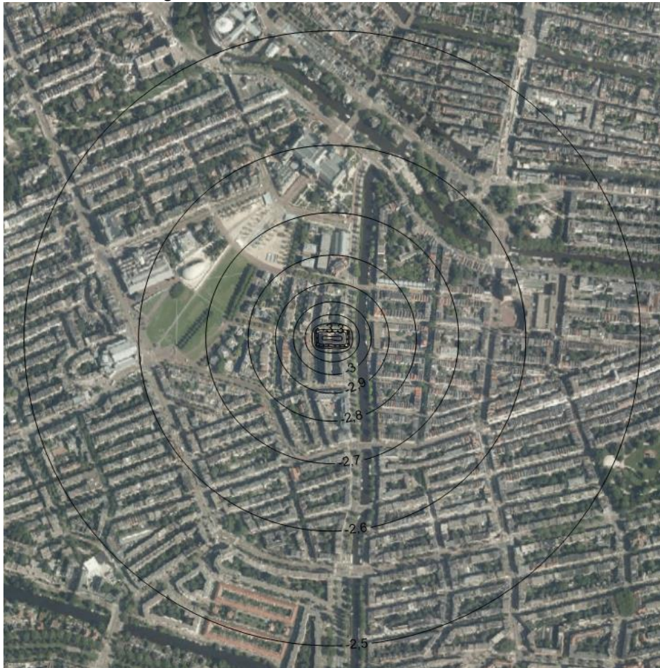
Figuur 5 – grondwaterstand t.o.v. NAP in Pleistoceen na 90 dagen spanningsbemaling (lijn met driehoeken is 0,05m verlaginglijn)
