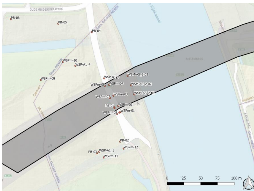
Figuur 6 Overzicht peilbuizen die geplaatst zijn t.b.v. de herstelwerkzaamheden
