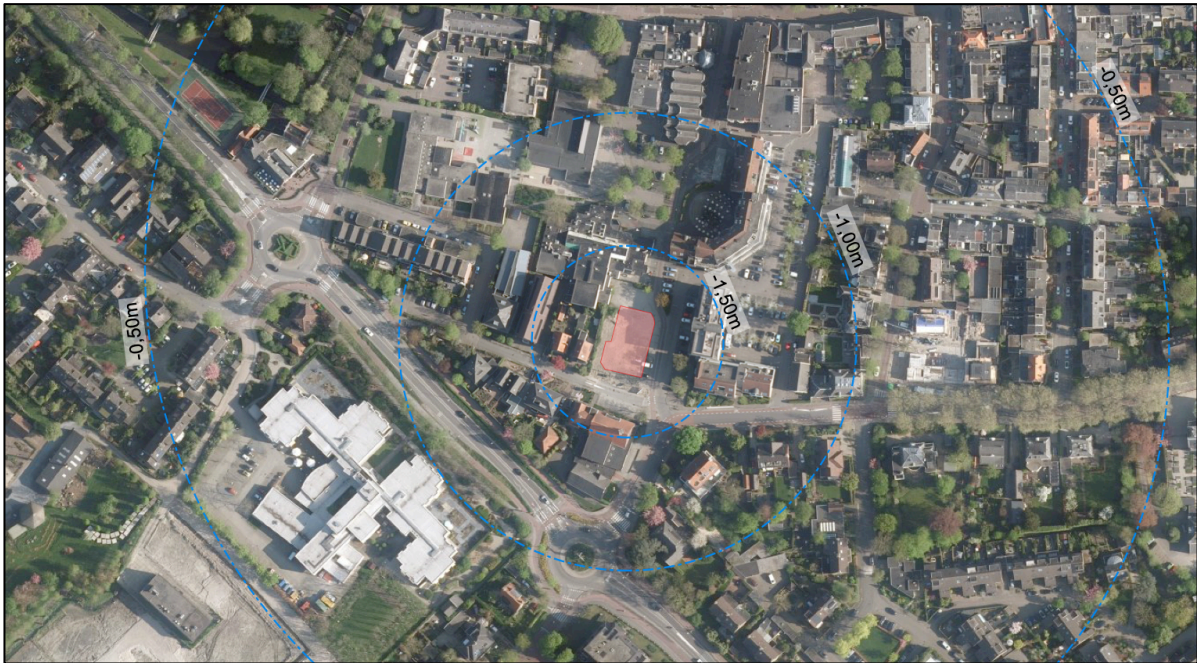
Figuur 13 – Verlagingscontour stijghoogte directe omgeving na 14 dagen in meters.
