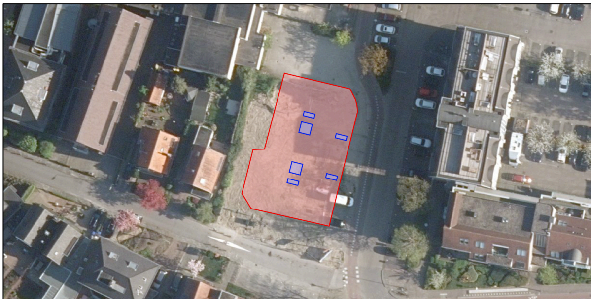
Figuur 4 – Bouwut, rood is bouwkuip met damwanden, blauw zijn de poeren.
