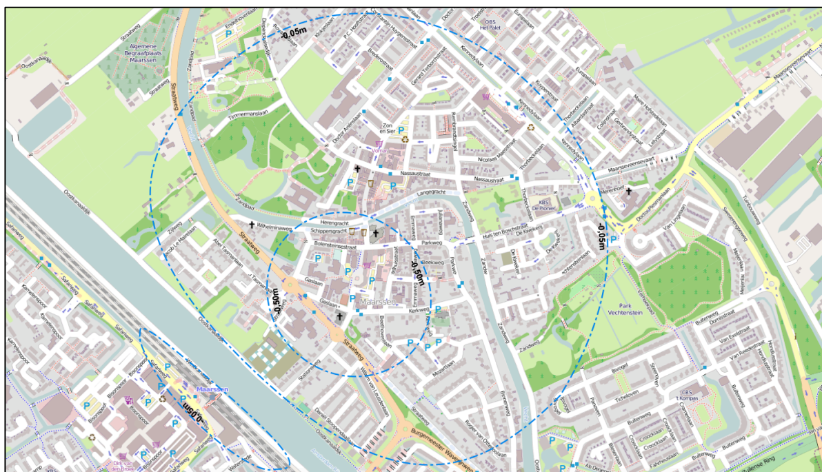
Figuur 12 – Verlagsingscontour stijghoogte met maximale invloedssfeer na 14 dagen in meters.
